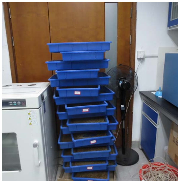
消防通道（门）被堵
